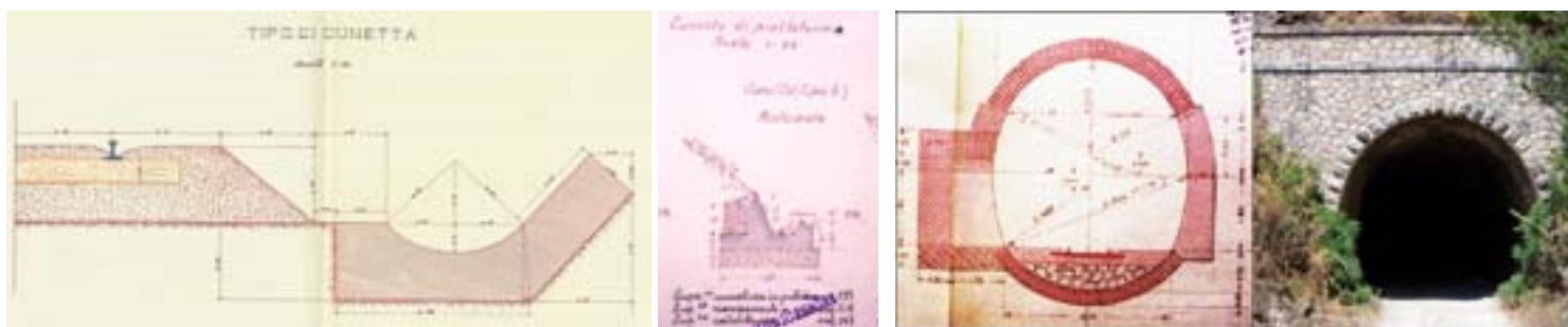
Da sinistra a destra due immagini relative alla ex ferrovia Palermo-Corleone-Sciacca: 10 e 11 sezioni di tipi di cunetta (progetto di massima, 1899, e progetti di manutenzione dei pendii limitrofi); 12 sezione e foto di tipo di galleria (dal profilo-sezione della ex ferrovia Bivio Filaga-Prizzi-Palazzo Adriano);
