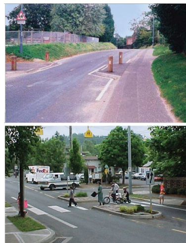
Figura 4.39 - rilievo Strettoie e isole centrali spartitraffico
