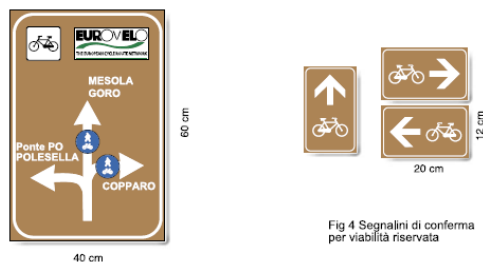
Fig 3: Cartello "turistico" con itinerari ricavato da modifiche delle figure 360 - 363 art 136 DPR 495/92 adatto anche per viabilità ordinaria
