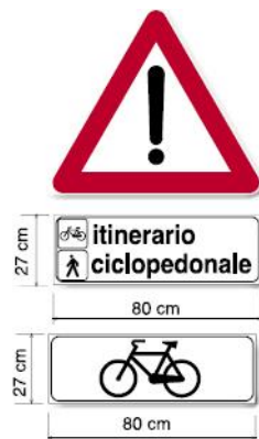
Fig 4: Possibile cartello di pericolo generico (fig. II, art 103 DPR 495/92, con pannello integrativo, (mod II 6 art 83 DPR 495/92) da porre su strada a viabilità ordinaria per segnalare la frequente e probabile presenza di ciclisti, ovvero dell'itinerario ciclopedonale (Eventualmente da utilizzarsi abbinato a limite di velocità 30 o meno vedi Tab 6c)
