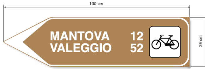
Fig 1: Segnale di direzione ottenuto dai segnali turistici per contesti extraurbani (tabella II 14a DPR 495/92)
