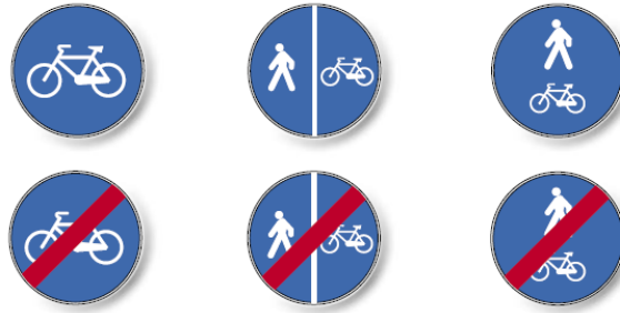
Fig1a: Cartelli di inizio e fine di pista ciclabile, (figg II 90 e 91, art 122, DPR 495/92)
