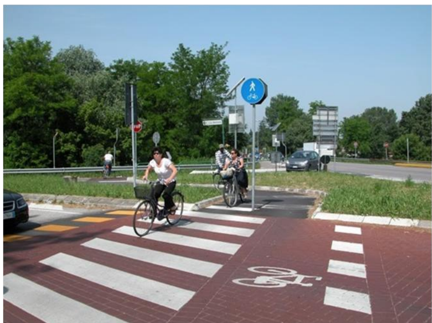
Figura 15 - Tipologia 4U attraversamento pedonale/ ciclabile urbano rialzato
