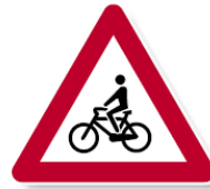
Fig 3: Cartello di pericolo per attraversamento ciclabile in strade extraurbane o urbane con velocità superiore a quello stabilito dall'art 142 comma 1 del CoS. (fig II 14 art 88, DPR 495/92)
