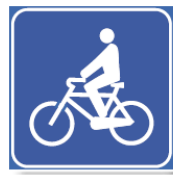
Fig 2: Attraversamento ciclabile. (fig II 324 art 135, DPR 495/92)
