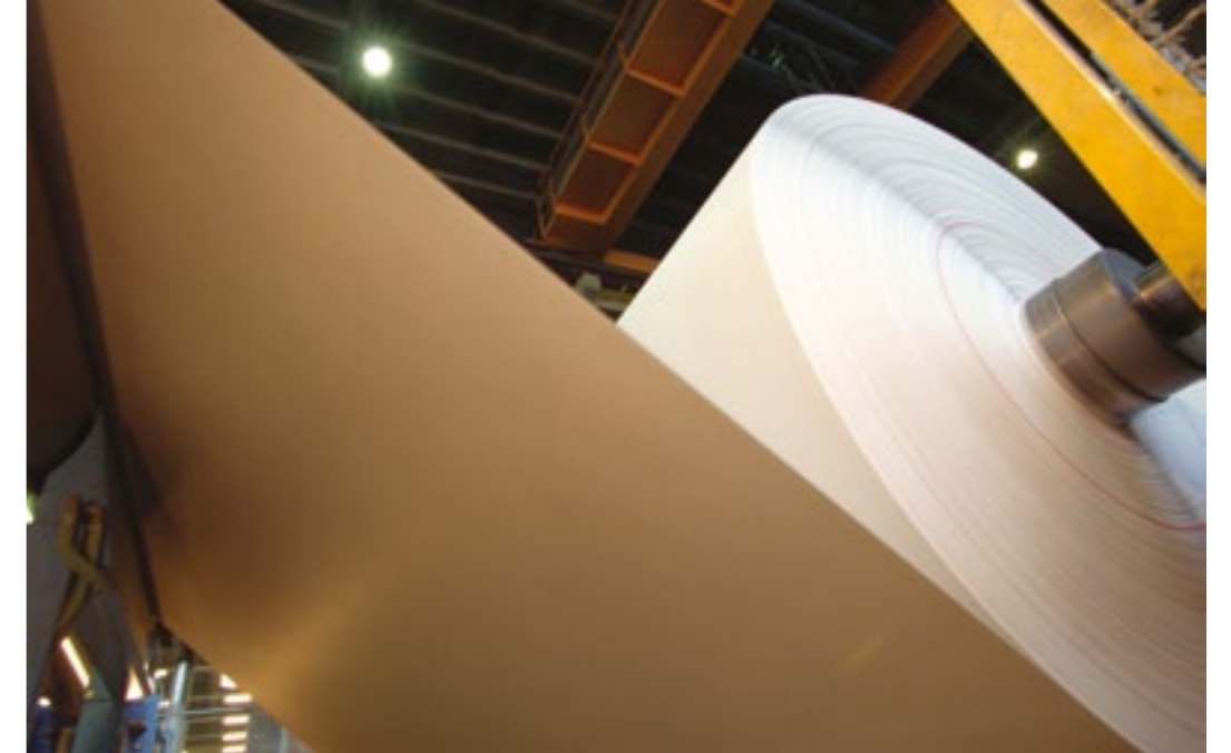
Il foglio di carta nasce e si forma in grandi bobine. The paper is wound onto large reels.
