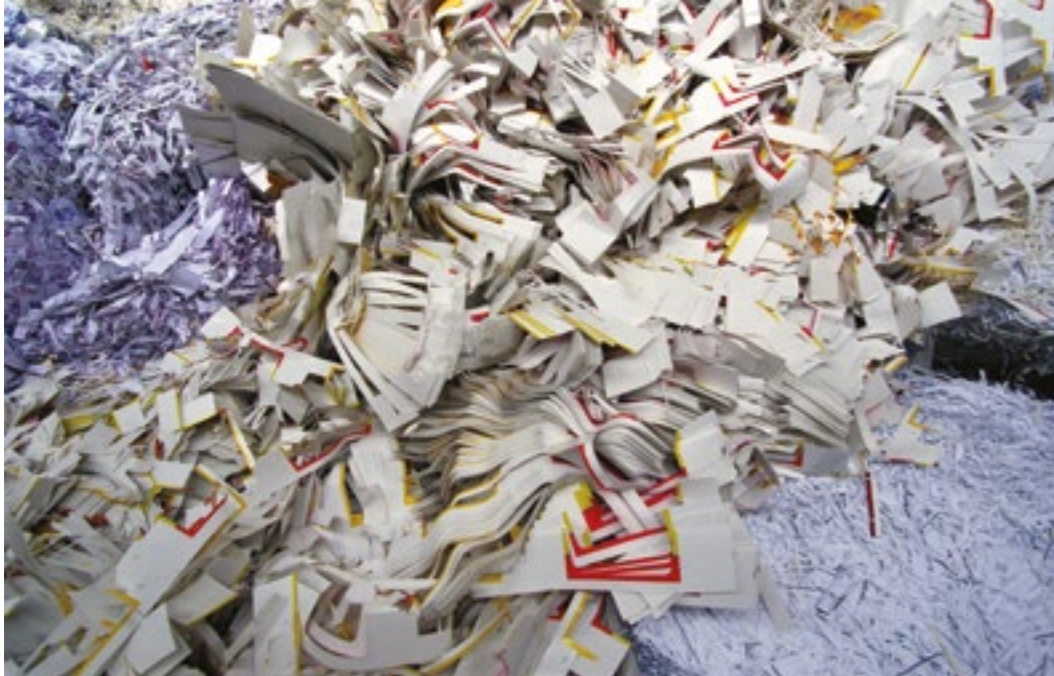
Carta riciclata, detta macero, pronta per alimentare la produzione degli impasti. Recycled paper, or pulp, ready to be fed into the mixture.
