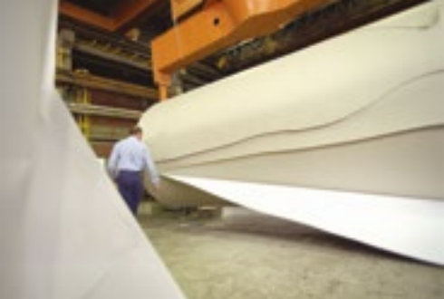
Il taglio della grande bobina effettuato fuori macchina. Cutting the large reel, off the machine.
