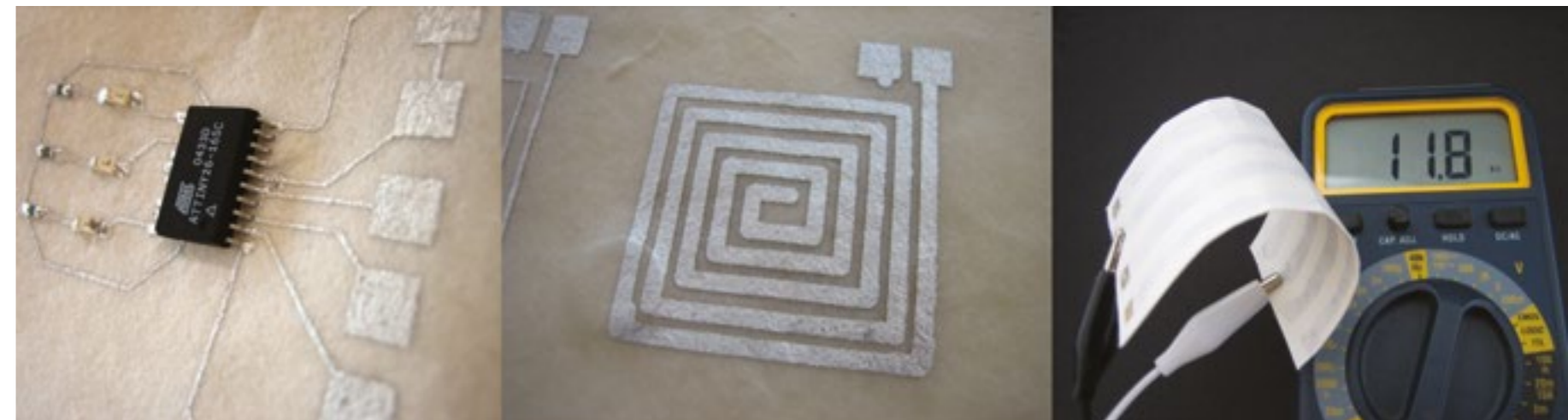
Progetto Pulp-Based Computing . Particolare con led integrati nella carta e intrusioni nella cellulosa della carta di sensori e microprocessori. (Marcelo Coelho)
