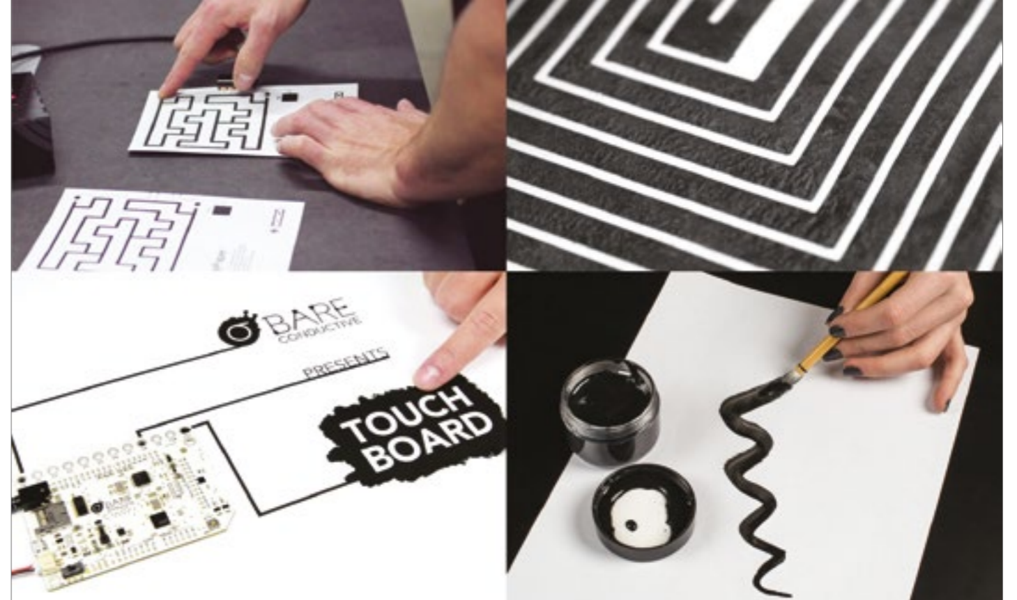
Circuiti realizzati con gli inchiostri conduttivi. Circuits built with conductive inks.
