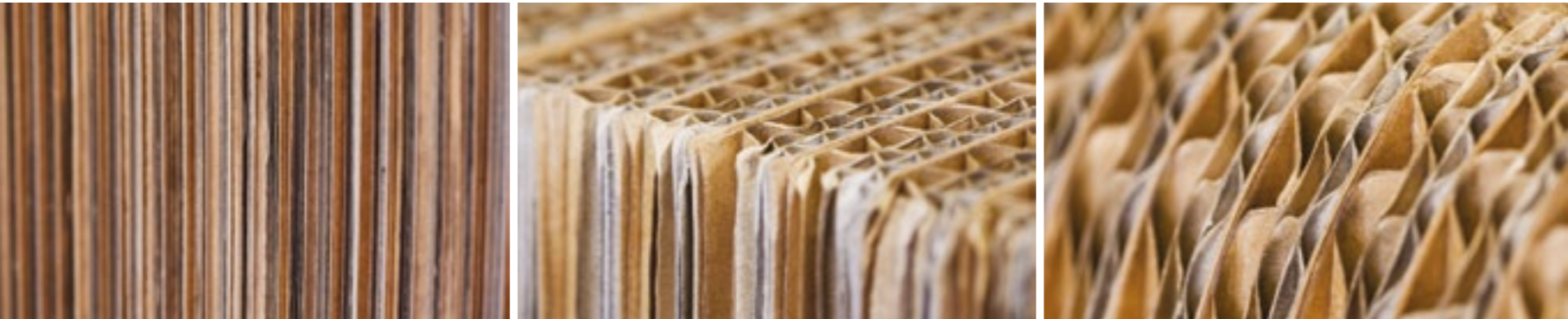
Cartoni con ondulazioni di diverse altezze. Immagini di dettaglio. Boxes with different size fluting, detail.
