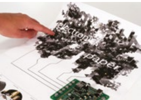
Poster interattivo realizzato in serigrafia con gli inchiostri conduttivi della Bare Conductive. Bare Conductive's interactive poster made by screen printing with conductive inks.
