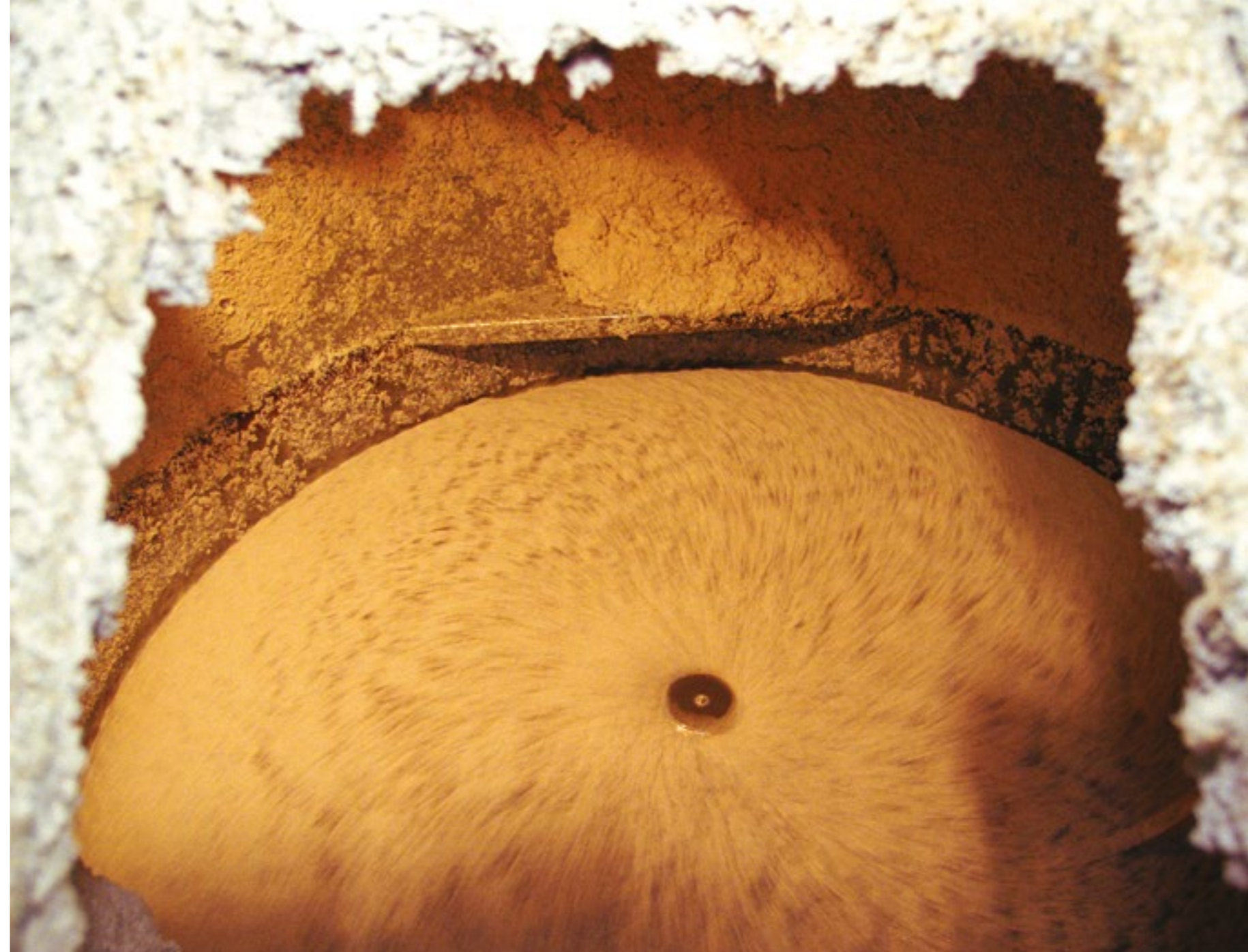
La produzione degli impasti parte dal pulper. Paper paste begins in the pulper.
