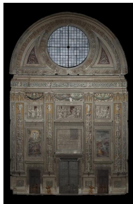
Fig. 10. Laboratorio LaRiFo, Politecnico di Milano, Polo territoriale di Mantova. Vista ortogonale della nuvola di punti della controfacciata con associazione del dato radiometrico (ortofoto-laser). Le immagini sono state acquisite indipendentemente dal dato laser. Visualizzazione generata con software Pointools.
