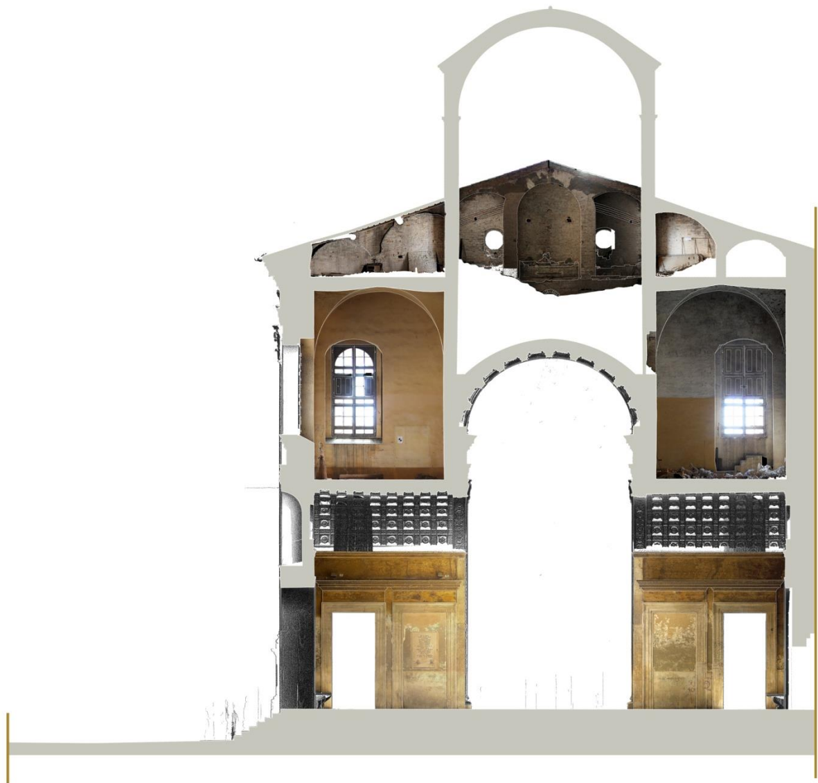
Fig. 11. Laboratorio LaRiFo, Politecnico di Milano, Polo territoriale di Mantova. Sezione trasversale Ovest del pronao della Basilica di S. Andrea a Mantova, Integrata con l'inserimento delle ortofotodigitali del vestibolo e delle ortofoto-laser degli ambienti soprastanti.
