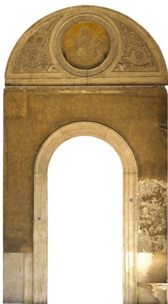
Fig. 8. Laboratorio LaRiFo, Politecnico di Milano, Polo territoriale di Mantova. Ortofoto digitale di una parete interna del pronao della basilica di S. Andrea, realizzata sulla base di un DSM generato dalla nuvola di punti laser (HDS3000).
