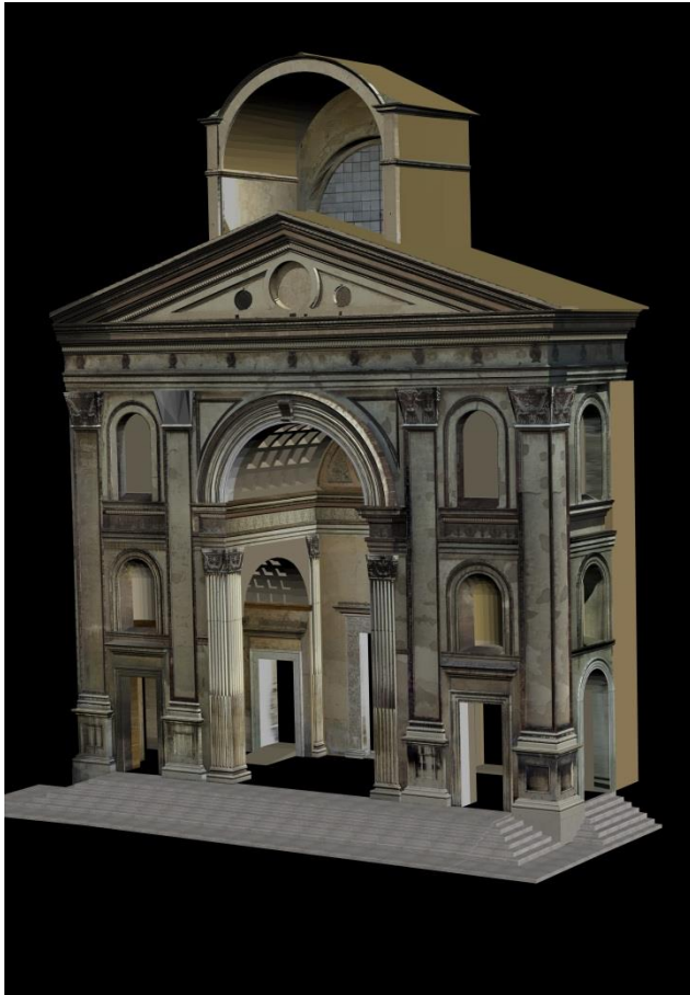
Fig. 6. Laboratorio LaRiFo, Politecnico di Milano, Polo territoriale di Mantova. Modello 3D del pronao della Basilica di S. Andrea a Mantova, mappato con le Ortofoto digitali (2008).
