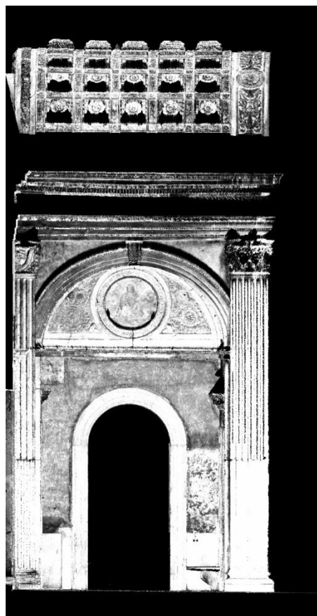
Fig. 5. Laboratorio LaRiFo, Politecnico di Milano, Polo territoriale di Mantova. Vista ortogonale della nuvola di punti del pronao di S. Andrea eseguita con Laser Scanner HDS6000. Visualizzazione generata con software Pointools.
