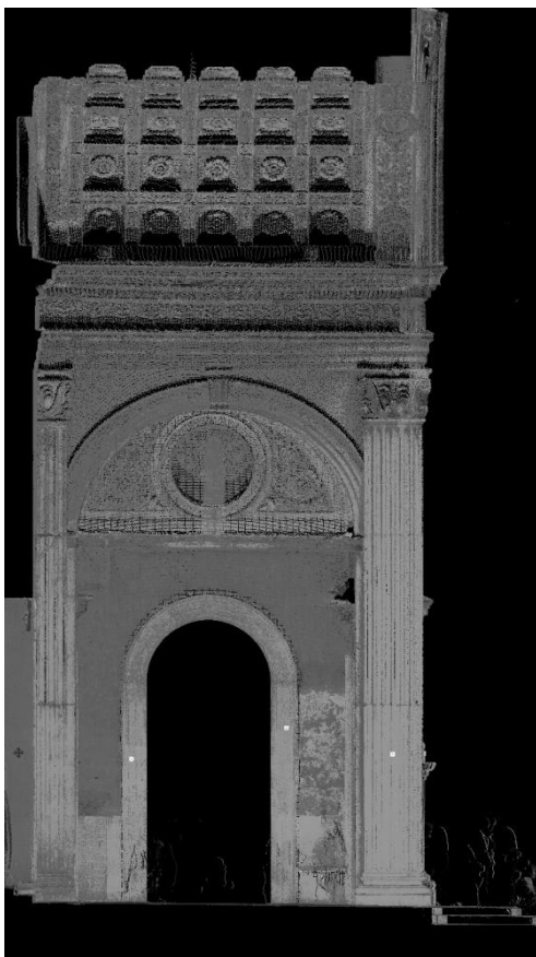
Fig. 4. Laboratorio LaRiFo, Politecnico di Milano, Polo territoriale di Mantova. Vista ortogonale della nuvola di punti del pronao di S. Andrea eseguita con Laser Scanner HDS3000. Visualizzazione generata con software Pointools.
