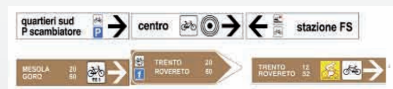
20 - Esempio di segnali verticali di direzione
