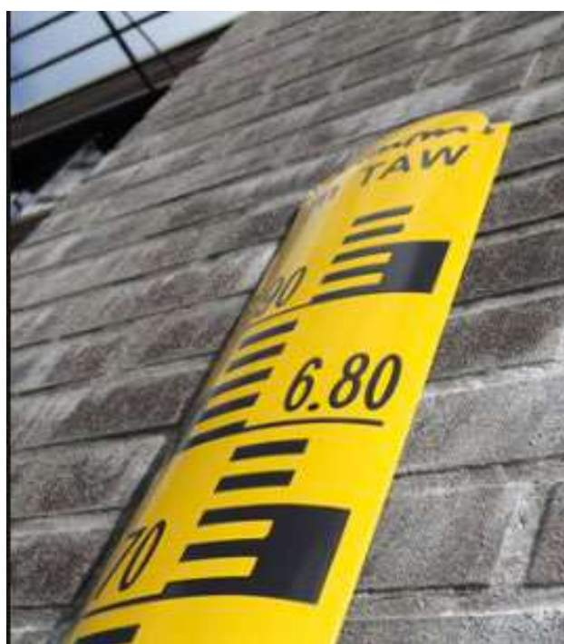
Figura 6: asta idrometrica di sicurezza
