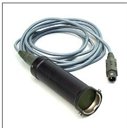
Il tubo Geiger per le radiazioni Gamma
