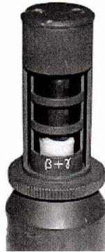
Figura 14 – Diaframma aperto, misure Beta + Gamma
